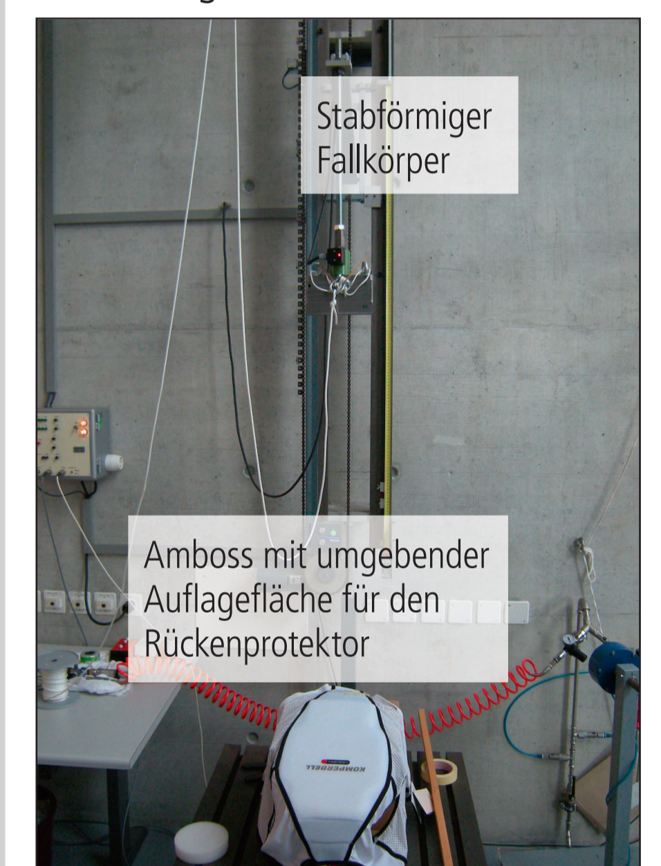
(Abb.1): Falltestapparatur nach EN 1621-2: Fallkörper mit Testplattform zur Arretierung der Prüfmuster
