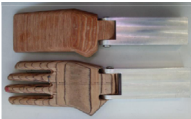
Abb. 3: Handprothese nach EN 14120 (oben) und modifizierte Hand mit Fingern (unten)
