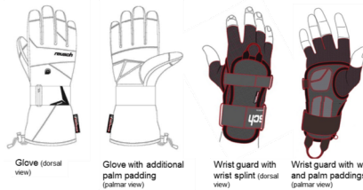
Abb. 1: Darstellung eines Handgelenkschützers, der dem „modularen“ Protektionskonzept zuzuordnen ist. Protektionselemente befinden sich sowohl im Handschuh als auch im eigentlichen Handgelenkschutz und können sowohl separat als auch kombiniert getragen werden (mit freundlicher Genehmigung von reusch®)
